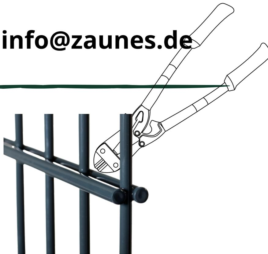
Doppelstabmatten zur **Ecke biegen** mit passendem Winkelschleifer oder Bolzenschneider. Die eine Seite der horizontalen Stäbe Daumenbreit durchtrennen, die anschließend in den gewünschten Winkel biegen.
